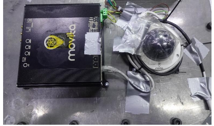
FOTOĞRAF 5.12. Z-Eksenli Mekanik Şok Testi Sonrası PICTURE 5.12. Z-Axis After Mechanical Shock Test
