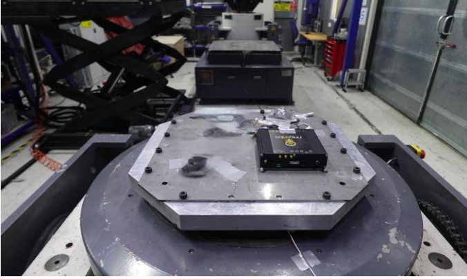
FOTOĞRAF 5.11. Z-Eksenli Mekanik Şok Testi Öncesi PICTURE 5.11. Z-Axis Before Mechanical Shock Test
