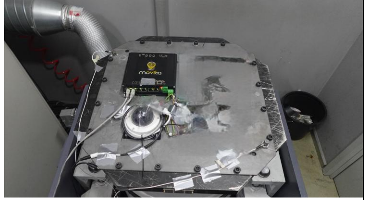
FOTOĞRAF 5.6. Z-Eksenli Titreşim Testi Sonrası PICTURE 5.6. Z-Axis After Vibration Test
