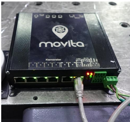
FOTOĞRAF 5.17. Tüm Testler Sonrası Fonksiyonel Kontrol PICTURE 5.17. Functional Check After All Test
