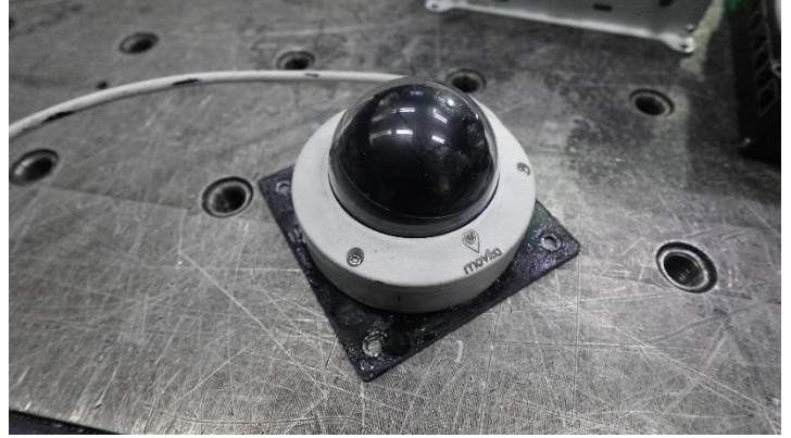
FOTOĞRAF 5.16. Serbest Düşme Testi Sonrası Test Numunesi PICTURE 5.16. The Test Sample After Drop Test
